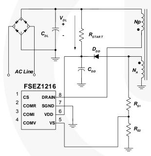
Figure 29. Startup Circuit
